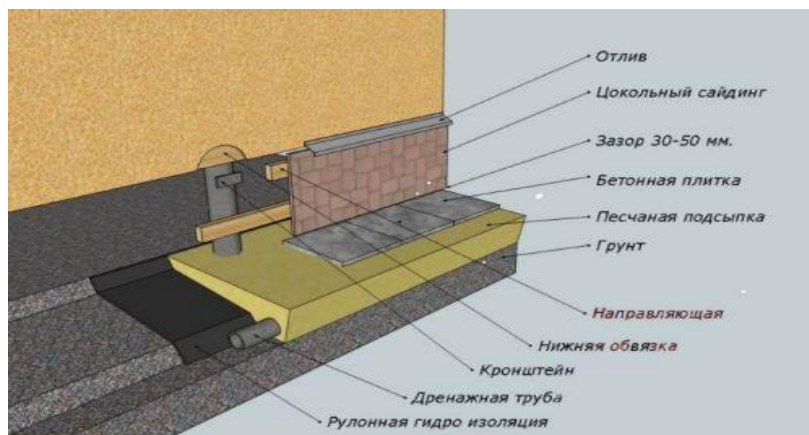
3-расм. Замонавий биоларнинг курсиси нам ўтказмаслик хусусиятига эга бўлган ва пойдевор конструкциясини намлигини қочириш учун дренаж усулида қурилган курсининг конструктив ечими.
