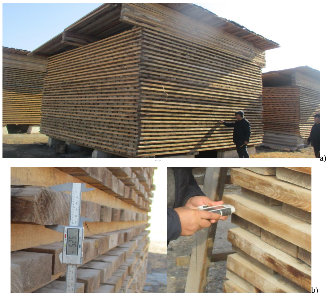
1-rasm. Buxoro mintaqaviy temir yo'llar unitar korxonasi xo'jaligi ochiq maydonlarida saqlanayotgan arralangan yog'och materiallari holat (a) va taxtlarning ko'ndalang kesim o'lchamlari, namligin o'lchash jarayoni (b).
